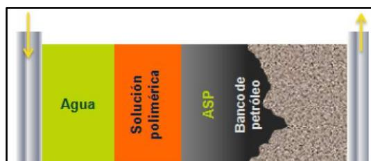
**Figura 14.** Esquema inyección de formulaciones ASP (figura 5. en [Castro, 2011](#))
